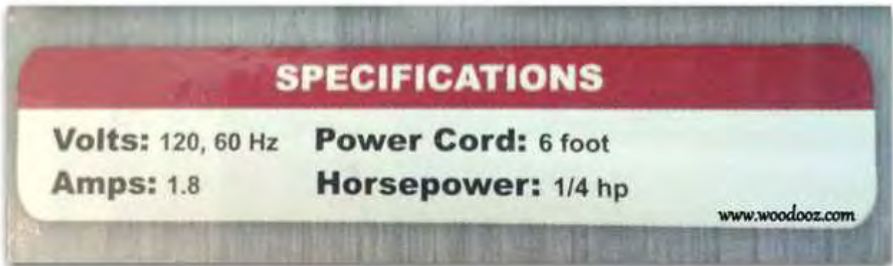
चित्र 5.2.9 शॉर्ट सर्किट से बचने के लिए सॉकेट में प्लग लगाने से पहले उपकरण और मशीनों पर उल्लिखित वोल्टेज देखें
