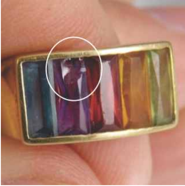
चित्र 3.3.7 सेटिंग टूल के किसी न किसी प्रयोग के कारण पत्थर क्षतिग्रस्त हो गया है
