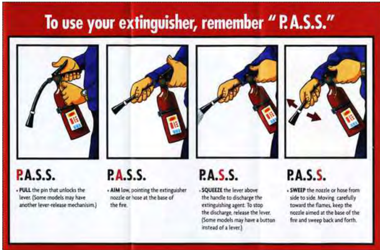
चित्र 5.4.6 अग्निशामक यंत्र के प्रयोग के चरण - आग बुझाने के लिए सही अग्निशामक यंत्र का प्रयोग करें
